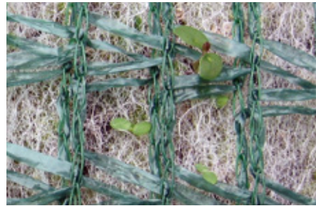
植物の出芽を阻害しにくい構造の綿状マットです。 (写真は双葉の出芽状況)
