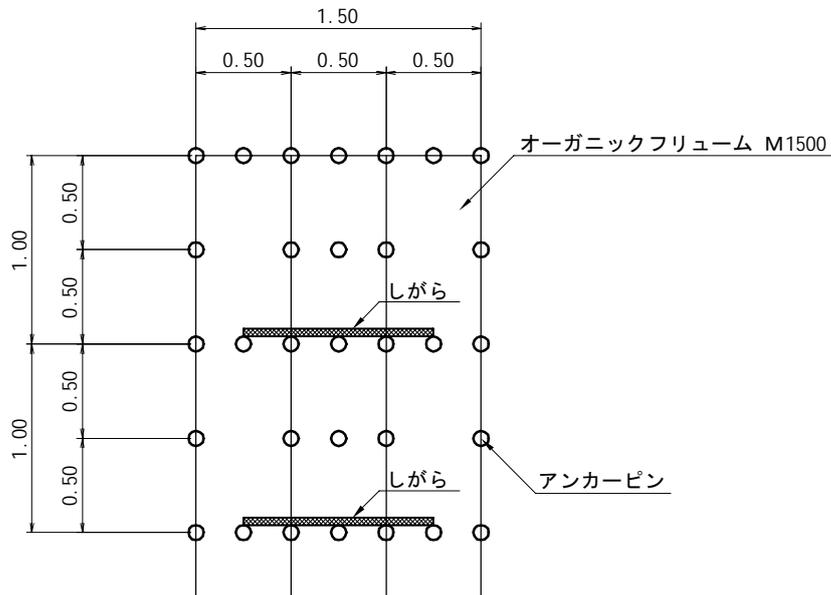
注2) : 植生マットの上下接続部は、上側のマットの下に、下側のマットがくるよう重ね合わせを行って下さい。
