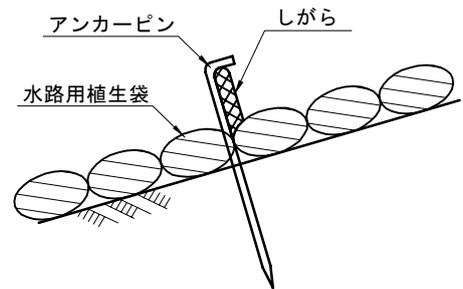
注1) : しがらは下流側からアンカーピンで支えるように固定する。
